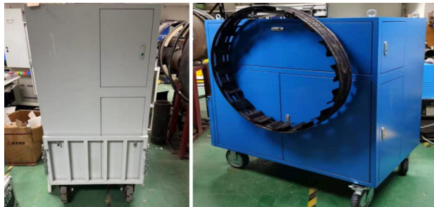
图6 便携式焊接移动工作站
